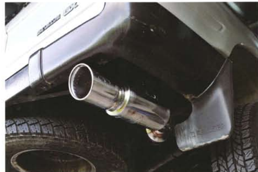
上：バンパー端面の内側に入っているため、ディバーチャーアングルにもさほど影響がないのがいい。下：装着前のガナドール。2分割式で接合部のフランジやブラケットまでピカピカのステンレス製だ。
