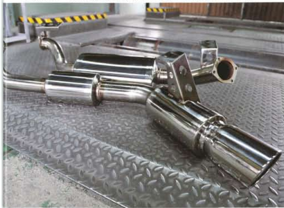
上：バンパー端面の内側に入っているため、ディバーチャーアングルにもさほど影響がないのがいい。下：装着前のガナドール。2分割式で接合部のフランジやブラケットまでピカピカのステンレス製だ。
