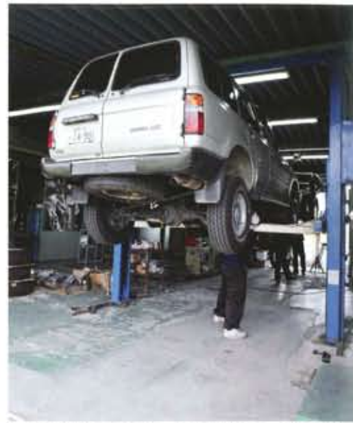
錆がひどく進行したマフラーは外すのが大変。交換を怠けると思わぬトラブルを引き起こす可能性もある。
