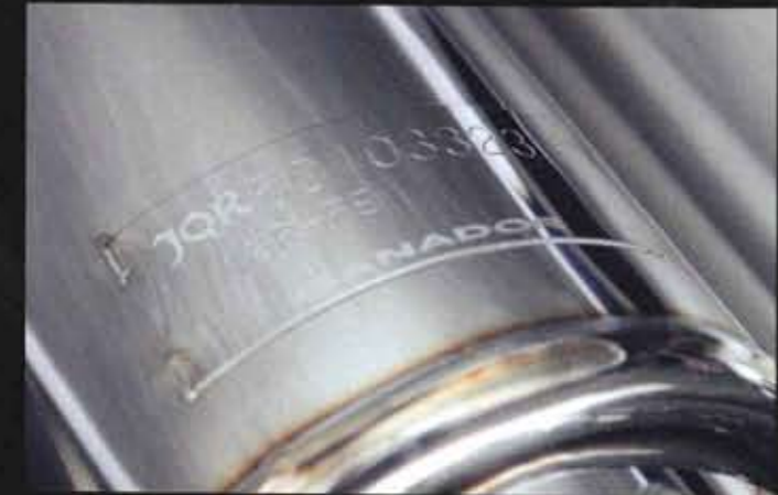
マフラー新規制に対応したマフラーに装着される「JOR」のプレート。2010年4月以降に生産されたクルマには、新規制に対応したマフラーでなければ、車検をクリアすることができない(写真はFJクルーザー用)。
