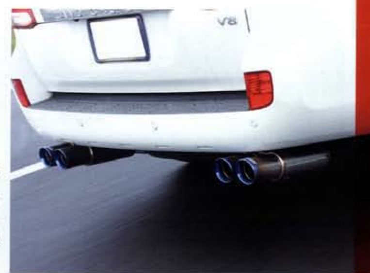
ランドクルーザーオーナーに人気のガナドールマフラー。今回は、左右4本出し・サークルエンド・ブルーカラーのPBSマフラーでテスト。同じコースをノーマル状態、ガナドールPBSマフラー装着して走行、満タン法による燃費計測を行なった。製品の価格やラインナップは、ホームページか先月号をチェック!
