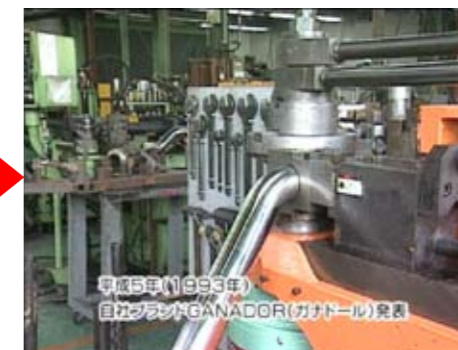
マフラー製作現場(パイプバンダー)
