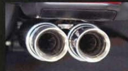
P.B.S.の特徴であるテール内部のスパイラルフィン構造。排気を整流する効果がある。
