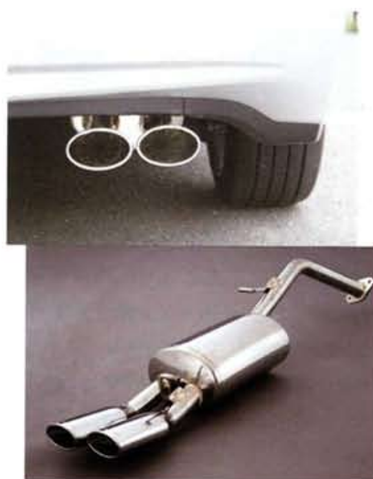
P.B.S マフラーは、排気を回転させるスパイラルフィン(写真上)によるテール構造が特徴。ステンレス製(30プリウス、7万1400円)とチタニウム製(同19万7400円)をラインナップ
